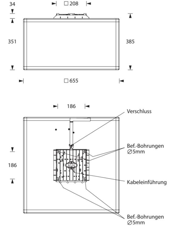
Kabeleinführung    Bef. Bohrungen    Verschluss
