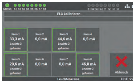
Abb. 84: Maske „Leuchten suchen“ (Einzelleuchtenüberwachung)
