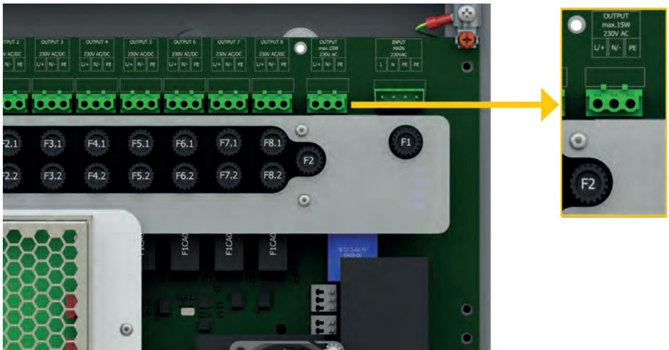
Abb. 20: Anschluss externe AC-Verbraucher
